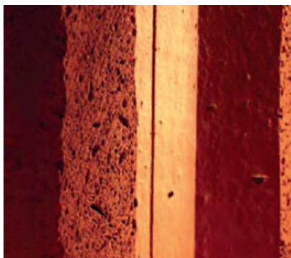
Рис. 6. Поризованная структура черепка
